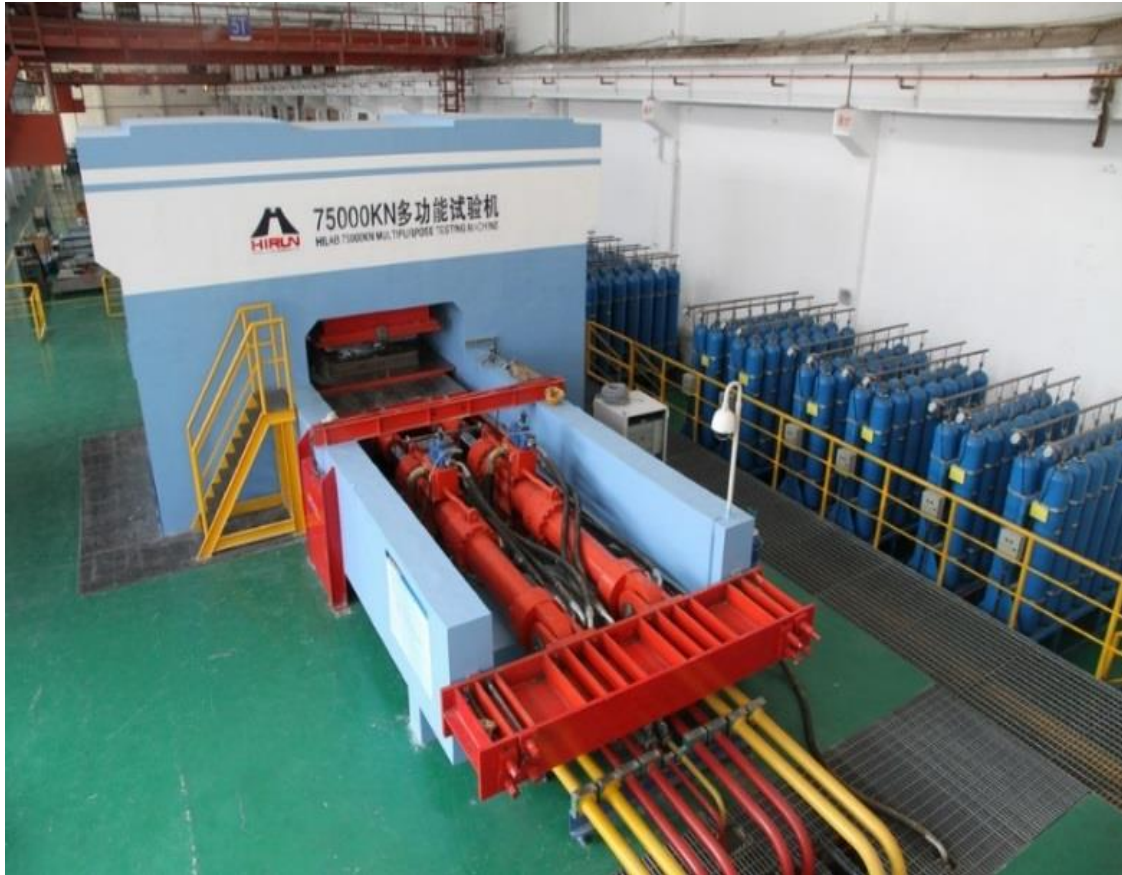
Macchina Test dei dispositivi sismici di proprietà HIRUN, Wuhan (Cina)
